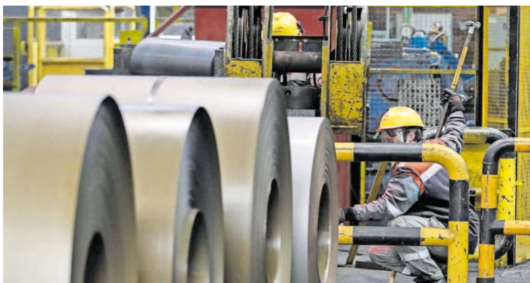
Interior de la planta de ArcelorMittal en la que se fabrica magnelis, acero con un recubrimiento metálico más resistente, en Avilés. EFE
